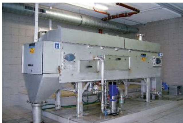
Захранвана със собствен филтрат помпа за пръскана вода
