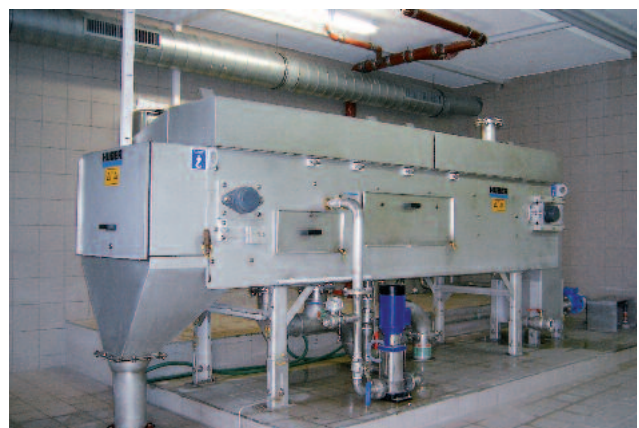
Mit eigenem Filtrat gespeiste Spritzwasserpumpe
