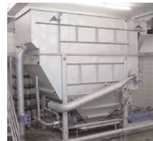
Ханс Купфер & Син GmbHCo. KG, Хайлсброн/Германия, Напорен флотатор HDF-10 с химическо стъпало, производителност: 100 м³/ч
