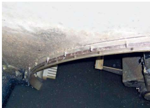
Полиуретаново уплътнение на входа на HUBER Барабанното сито LIQUID
