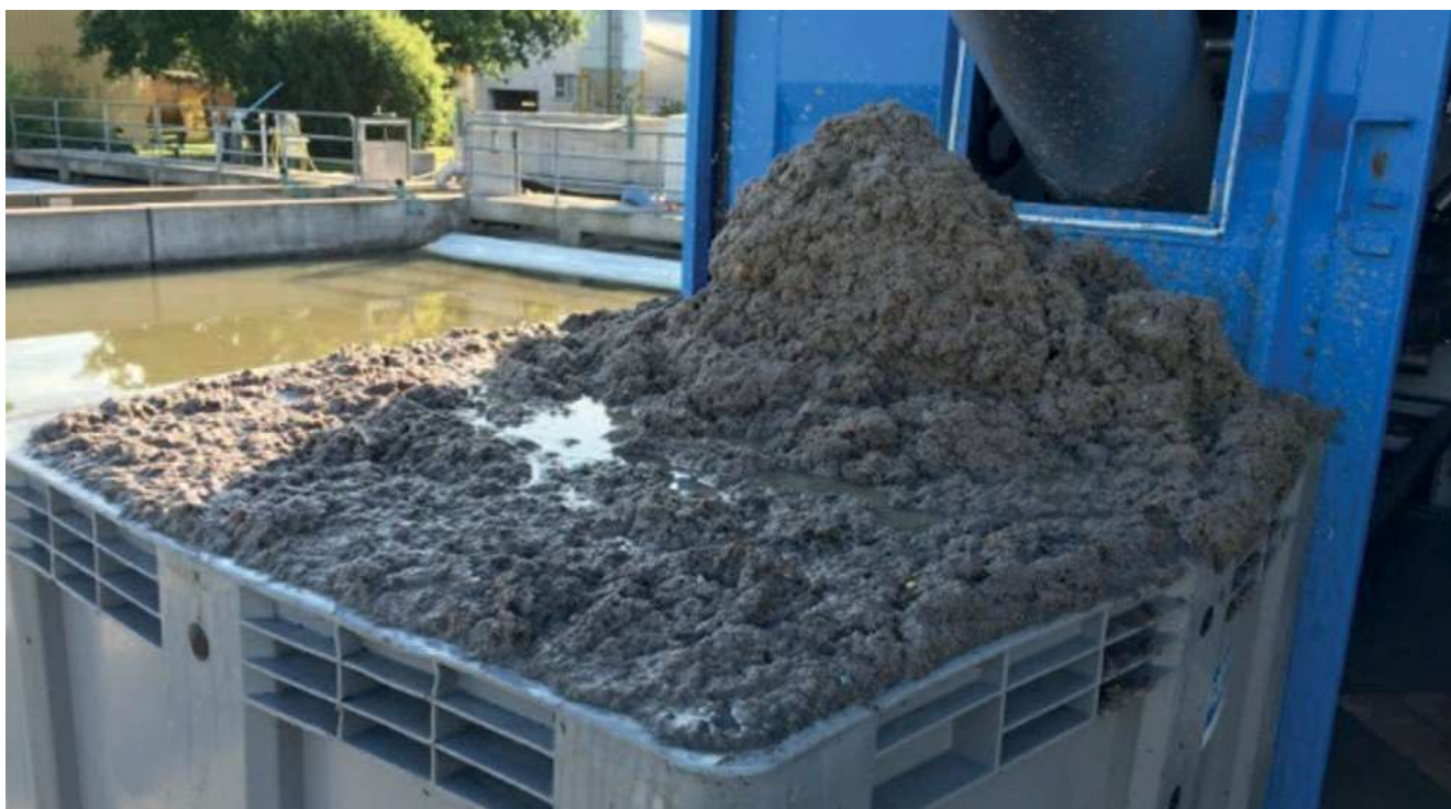
Отделена отсята маса от HUBER Барабанно сито LIQUID Mesh: Работата на биологичното стъпало се облекчава и по този начин в метантанка може да бъде произведен повече газ.
