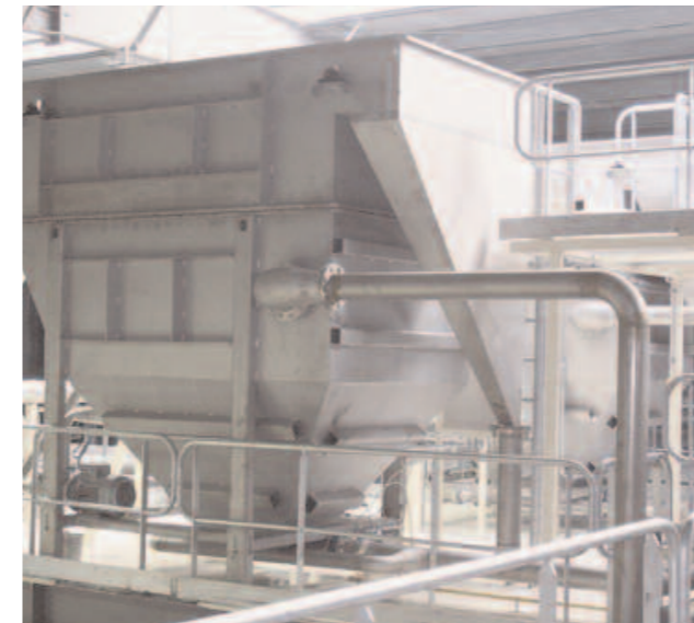
Фабрика за хартия Kronostar, Русия Съоръжение за напорна флотация HDF-7 производителност 70 м³/ч
