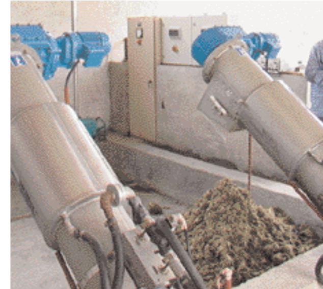
Фабрика за хартия Lingoang, Китай: предварително механично пречистване с фина сито HUBER ROTAMAT® Ro 2, 1 мм, задържане на твърдите частици > 60 %
