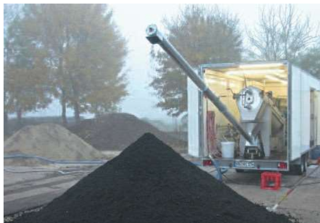
Обезводняване срещу заплащане с мобилна HUBER Шнекова преса Q-PRESS®
