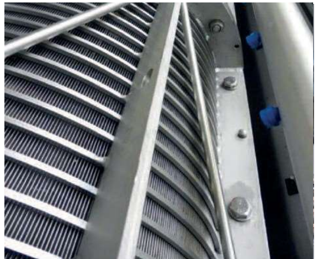
Стабилен пресяващ кош с процепи от неръждаема стомана
