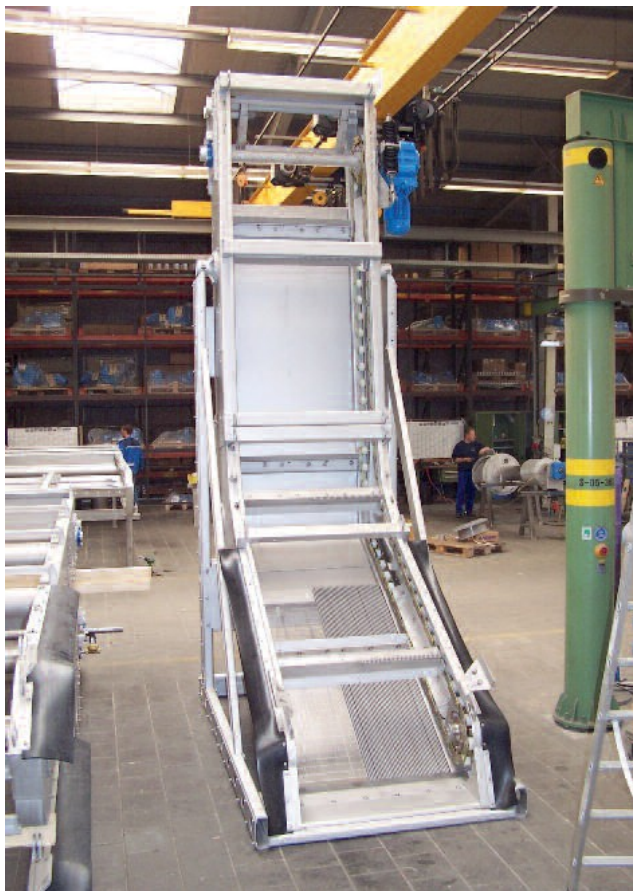
HUBER Rake-Max®-hf преди експедиция от завода – вижда се ясно плоския и затова хидравлично благоприятен пресецащ сектор
