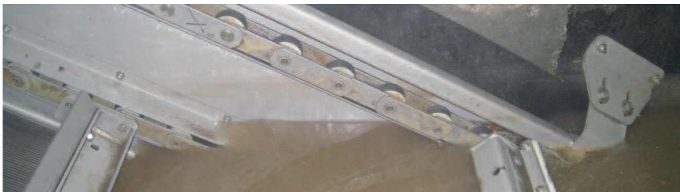
Въз основа на извънредно плоско наклонената повърхност на решетъчната скара протичаната пресяваща зона на RakeMax®-hf е почти двойно по-голяма от проточния профил.
