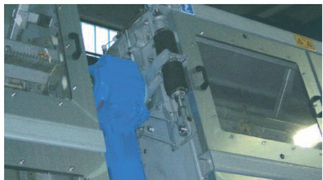
*Eingebaute Überlastsicherung (Drehmomentwippe), die bei Überlast den Rechen zuverlässig vor Beschädigung schützt und gleichzeitig ein elektrisches Signal abgibt. Aufgrund des Konstruktionsprinzips ist eine sehr gute Einstellbarkeit sowie eine kontinuierliche Überwachung gegeben.*
