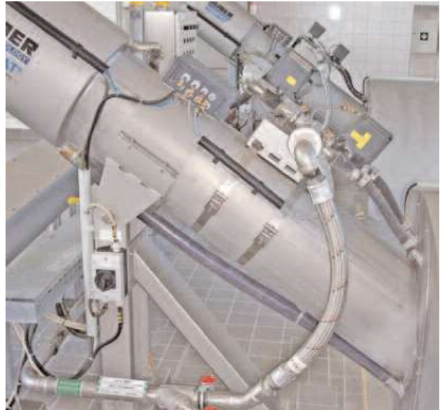
Монтаж в канал на HUBER Фина решетка ROTAMAT® Ro1 с вградена промивка за отсятата маса IRGA
