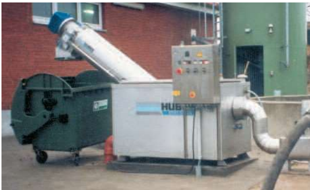
ROTAMAT® Приемна станция за фекални утайки Ro 3.1 с фина решетка ROTAMAT® в отопляемо и изолирано изпълнение
