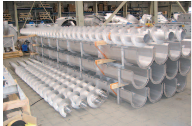
Fertigung der Transportschnecken Ro 8 und Ro 8t im Werk in Berching
