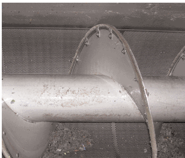
Щадящо отсятата маса принудително почистване на радиалната пресяваща повърхност
