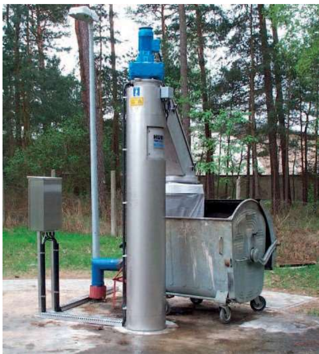
Изгодно отстраняване на отсятата маса чрез кръгово устройство за опаковане в чували
