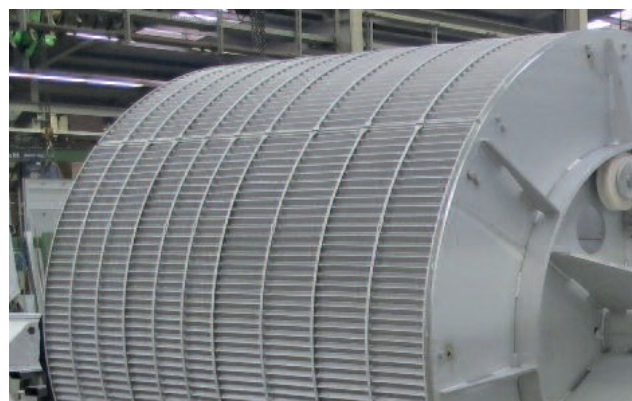
Пресяващ кош на сито ROTAMAT® RPPS Star liquid с нагъната перфорирана плоча
