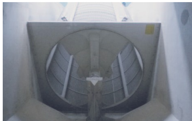
RPPS Star liquid с нагънат пресяващ кош позволява до 30% по-висока производителност при големини на кръглите отвори от 1/1,5/2 мм.
