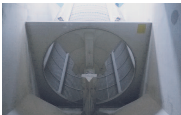
RPPS Star liquid mit gefaltetem Siebkorb ermöglicht um bis zu 30 % höhere Durchsatzleistung bei Lochweiten von 1 / 1,5 / 2 mm.
