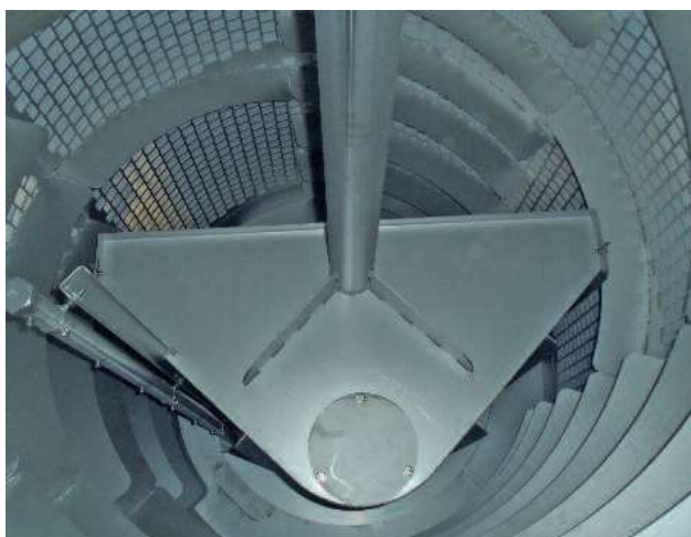
Сепарация на най-фини твърди частици чрез най-финия пресяващ барабан HUBER RoMesh®
