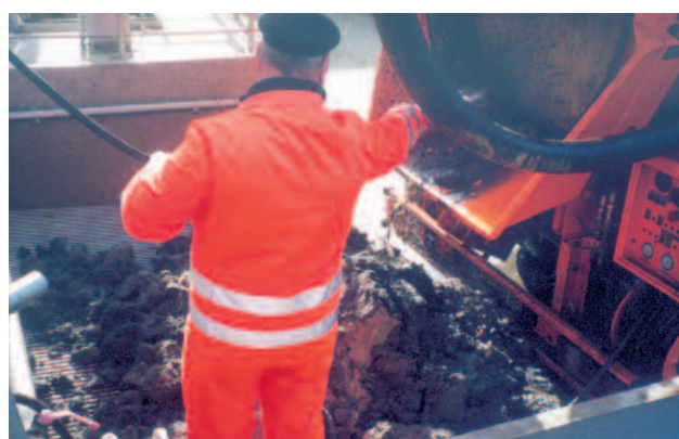
Tankfahrzeugentleerung auf dem Rüttelrost
