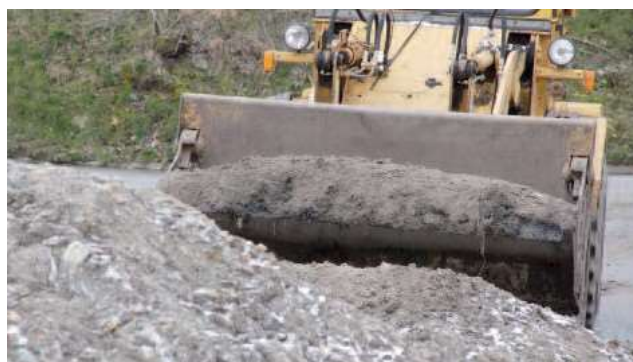
Приемателен бункер с прътова скара и вграден, хоризонтален дозиращ шнек
