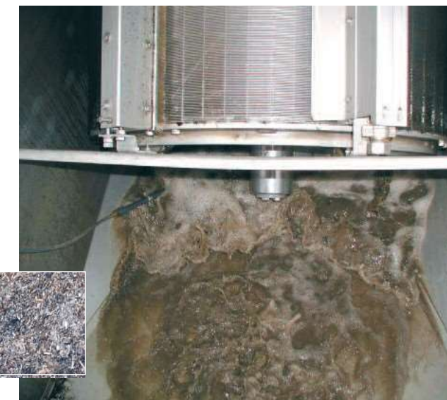
Пресяване при 1 мм и обезводняване (СВ ≈ 30%) на органичните частици с HUBER сито-съоръжението ROTAMAT®.
