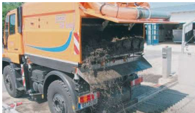
Приемателен бункер с прътова скара и вграден, хоризонтален дозиращ шнек
