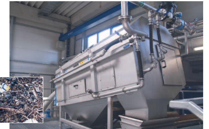
Auswaschen und Abtrennen aller Grobstoffe > 10 mm mit der ROTAMAT® Waschtrommel
