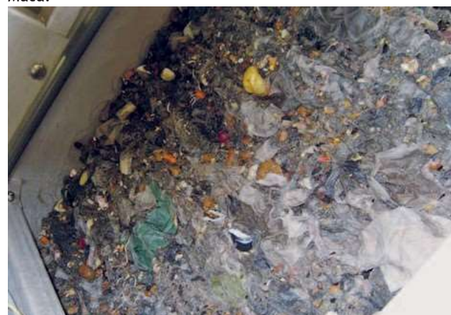
HUBER Стъпкова решетка STEP SCREEN® SSF: Степената на сепарация е реализирана чрез много фините процепи и образуващата се килим от отсята маса. Ефектът на самопочистване се гарантира от един подвижен ламелен пакет.
