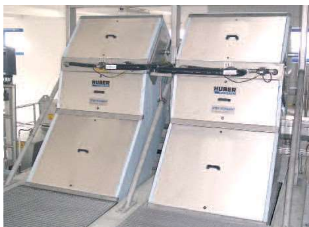
Две HUBER Стъпкова решетки STEP SCREEN® SSF в паралелни канали
