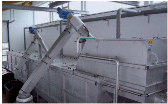
Sauberer Rechengut- und Sandfanggutaustrag bei der ROTAMAT® Kompaktanlage Ro 5
