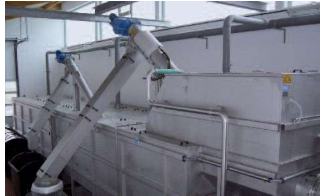
Чисто изнасяне на отсята маса и пясъчен пулп при компактното съоръжение ROTAMAT®Ro5
