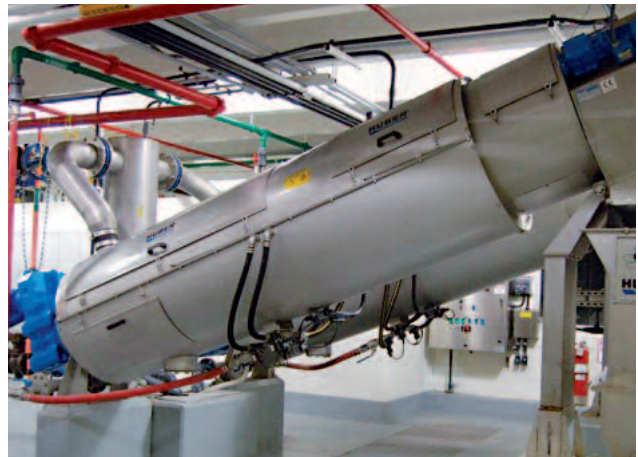
ROTAMAT® Schneckenpresse RoS 3 spezifischer Leistungsbedarf < 10 kWh/t TR
