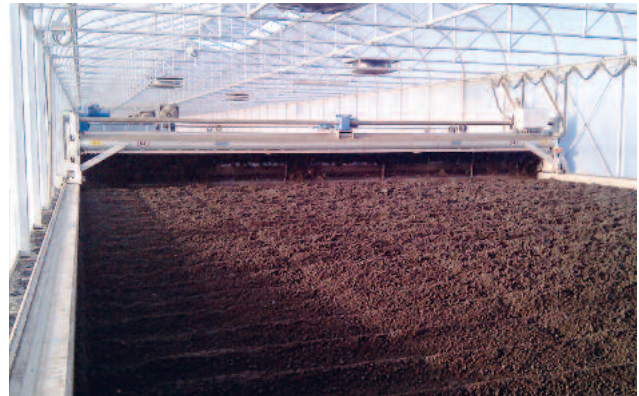
Aus entwässertem Klärschlamm wird trockenes Granulat mittels des HUBER SRT-Verfahrens
