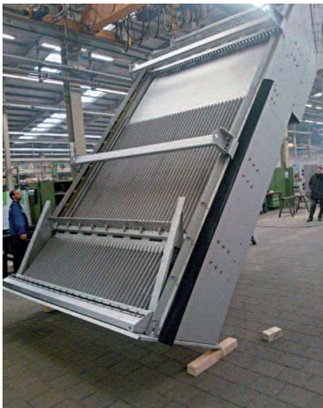
HUBER Груба решетка TrashMax® след сглобяване в подготовка за пробен пуск
