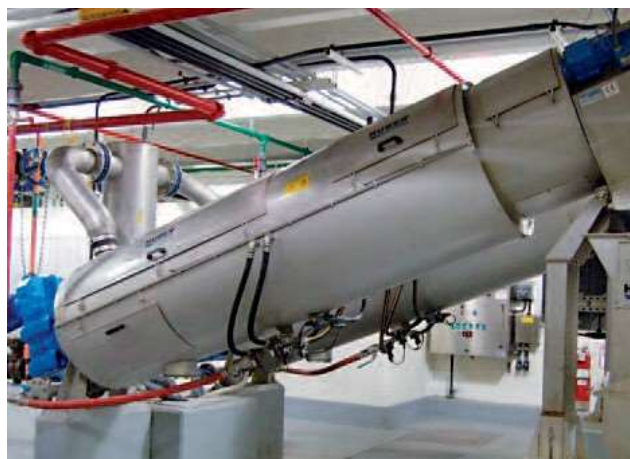
Шнекова преса ROTAMAT® RoS3 специфично необходима мощност < 10 kWч/т СВ
