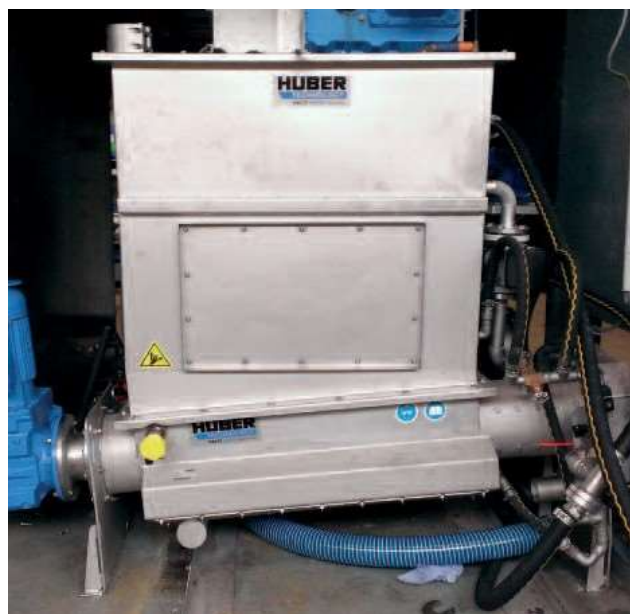
HUBER Промивната преса WAP® liquid със сменяема перфорирана ламарина и размер на кръглите отвори от 0.75/1/1.5 мм
