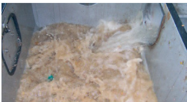
Помпеното работно колело генерира силни турбуленции в промивния резервоар
