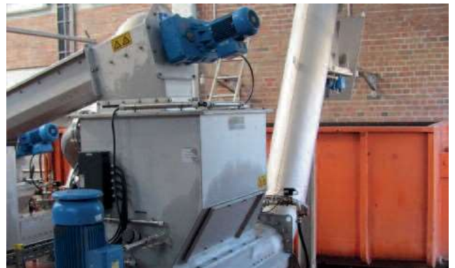
Промивна преса HUBER WAP захранвана посредством коритообразен транспортен шинек ROTAMAT® Ro 8t за резултати на обезводняване до 45% СВ
