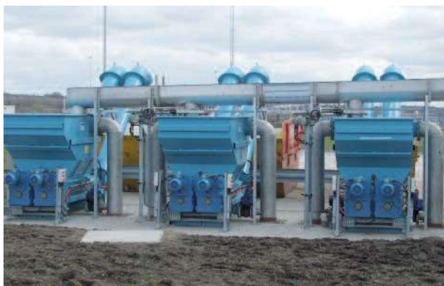
ПСОВ Кностроп (Великобритания): 2 милиона ЕЖ HUBER Воден улей HLC: 20 м 3 отпадъчна вода на секунда
