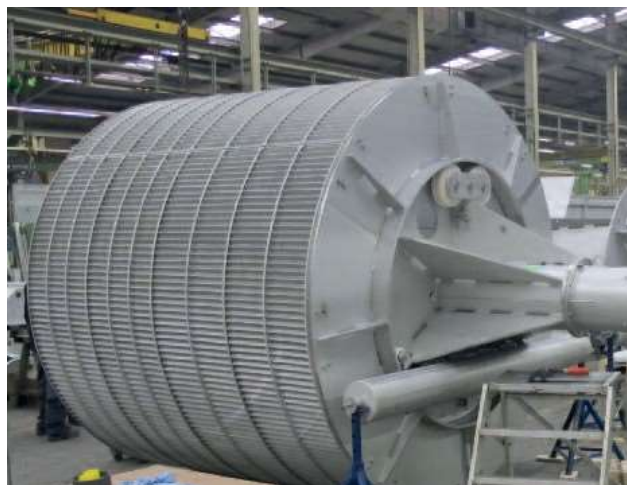
HUBER Сито ROTAMAT® с диаметър 2600 мм с 1 мм диаметър на кръглите отвори.
