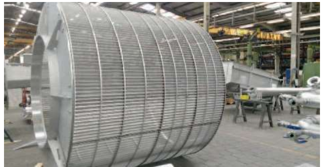
Пресяващ кош на ROTAMAT® STAR с диаметър 2600 мм и 1 мм диаметър на кръглите отвори. Байцвана и пасивирана в пълна вана.
