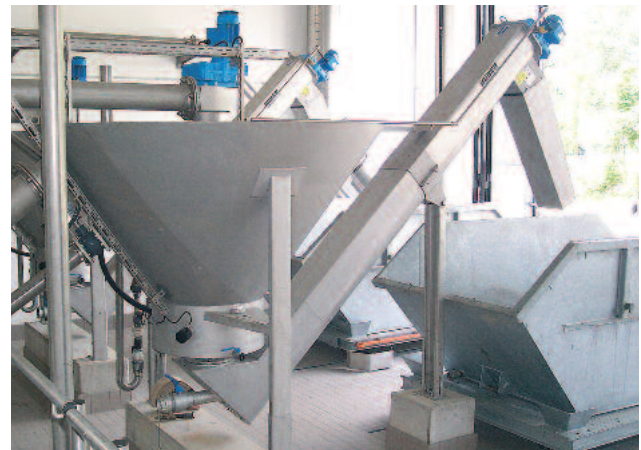
Entsorgungskosten senken und die Hygiene dabei verbessern – mit der HUBER Coanda Sandwaschanlage RoSF4 möglich.
