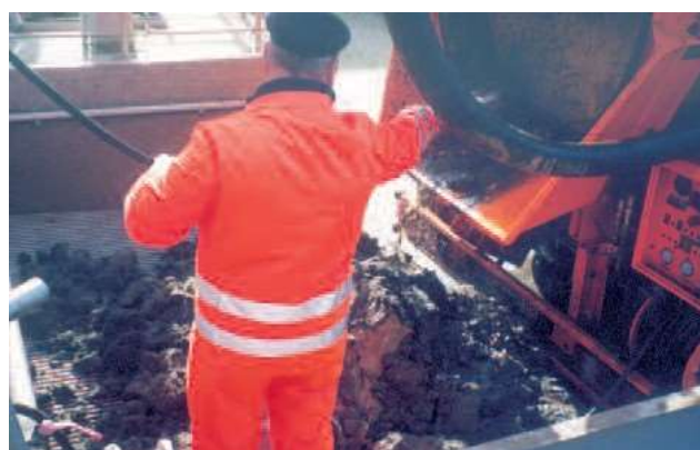
Изправване на транспортното средство върху вибрационната скара
