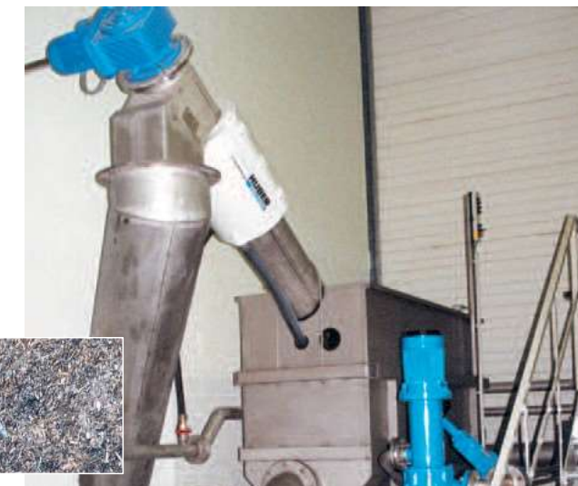
Пресяване при 1мм и обезводняване (СВ ≈30%) на органичните частици със сито-съоръжението ROTAMAT®.
