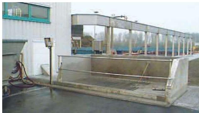
Приемателен бункер с прътова скара и вграден вертикален дозиращ шнек
