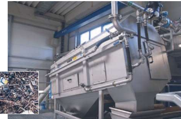
Промиване и отделяне на всички груби частици >10мм с промивния барабан ROTAMAT®
