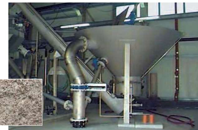
Промивен пясък от COANDA съоръжението за промиване на пясък със загуба при изгаряне <3%, големина зрънца до 10 мм, СВ >90%
