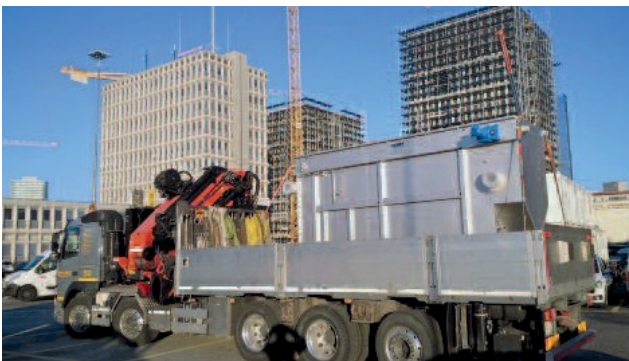
Битова отпадъчна вода; 1x RoWin C8; без предварително пресяване терм.мощност на извличане до 500 kW
