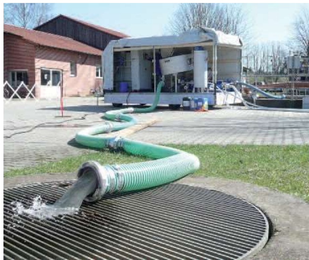
Мобилен HUBER Дисков съгстител S-DISC в ремарке на лек автомобил; на преден план изтича бистър филтрат
