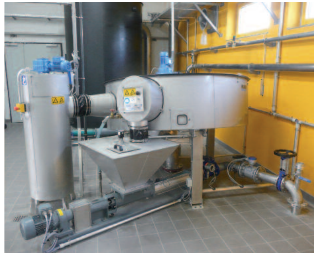
HUBER Scheibeneindicker S-DISC zur Eindickung von 35 m 3 /h
