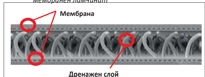
Напречен разрез чрез BIO-CEL® мембранен ламинат (източник: MICRODYN-NADIR)
